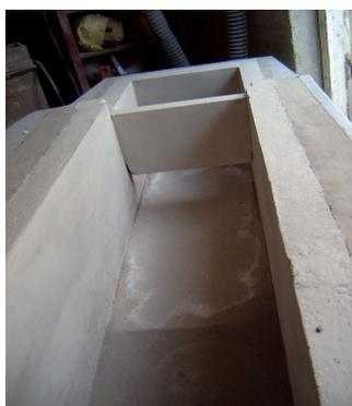
Под электрической плавильной печи Stotec (“Стотек”) с использованием материала Capiral 105SR (Кэпирэл 105 CP) (температура кожуха менее 40 градусов по шкале Цельсия)
